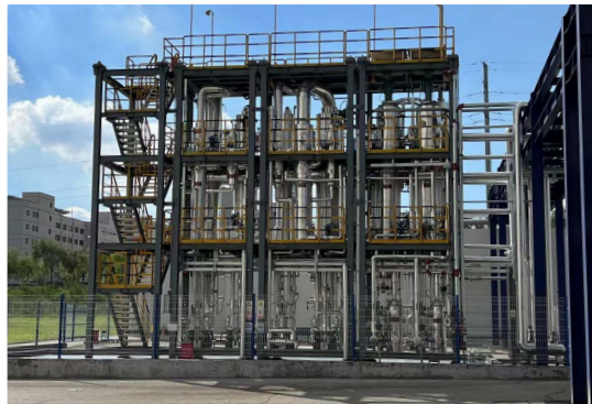
京东方鄂尔多斯第 5.5 代 LTPS-LCD/AMOLED 生产线废有机溶剂回收系统
