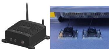
车载轨道声纹检测仪是轨道动态不平顺病害检测设备，检测分析内容包括：车体振动加速度局部超限分析与晃车原因诊断、车辆运行平稳性分析、车厢内噪声检测分析与极值噪声原因诊断、车厢内噪声与振动数据综合分析。
