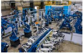
图 1. 车身焊装自动化生产线
