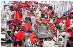
图 3. 新能源汽车焊装自动化生产线
