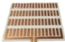
陶瓷覆铜基板 (DBC) 可广泛应用于: 电力电子模块、半导体致冷基片、COB 倒装陶瓷线路板、LED 封装与照明、陶瓷厚膜基板、汽车逆变系统、军工航天产品等科技领域。
