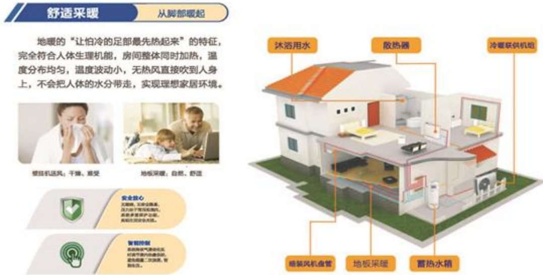
图6：空气源热泵机组供暖方案
