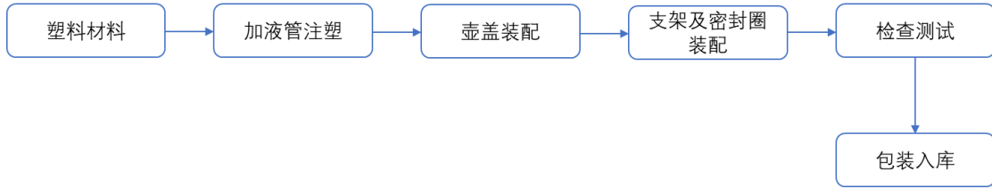
(4) 冷却歧管产品生产流程图
