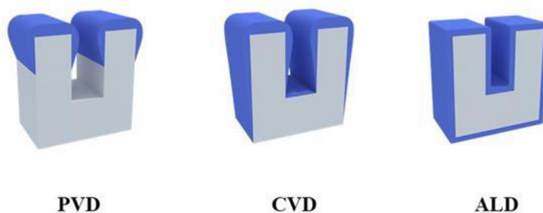
PVD、CVD、ALD 薄膜沉积效果示意图
