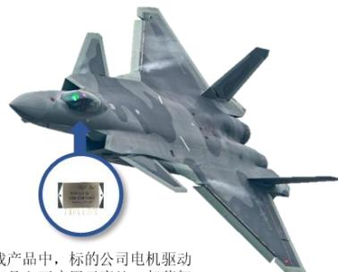
机载产品中，标的公司电机驱动器产品主要应用于座舱、起落架等的电动机构，用于驱动、控制电机启动、停止、正反转及调速。
