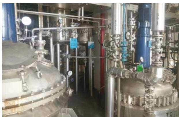
植化二车间结晶工艺改进，减少洗涤废水方案
