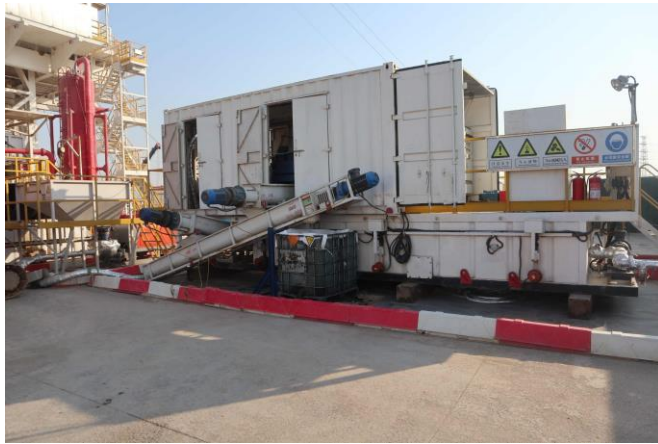
▲油基钻屑原位减量化处理装置
