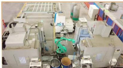
幕墙结构连接件自动化生产线
