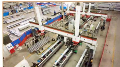
幕墙铝立柱自动化生产线
