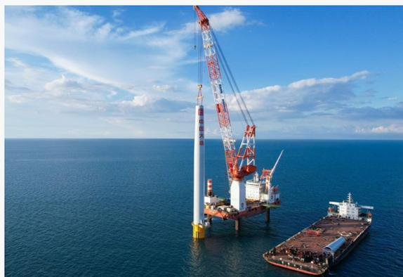
▶ 风电安装船在进行风机吊装
