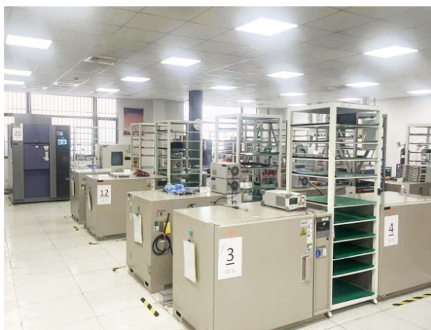
可靠性实验室已获 CNAS 认可, 能够对集成电路实施多种类型的可靠性试验, 包括 ESD、环境实验、寿命实验等。
