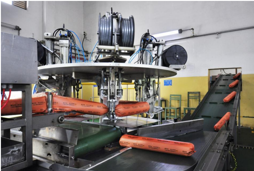
图五 乳化炸药生产线
