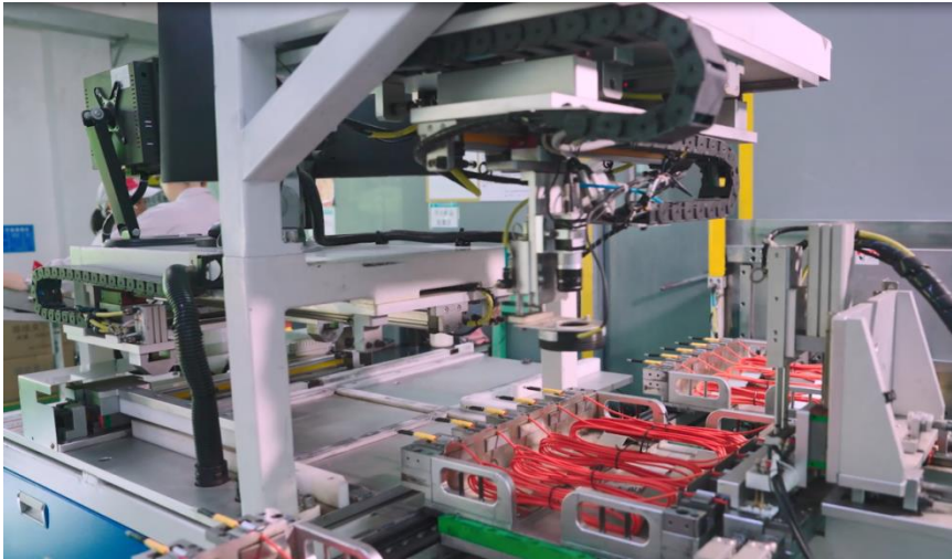
图六 电子雷管生产线
