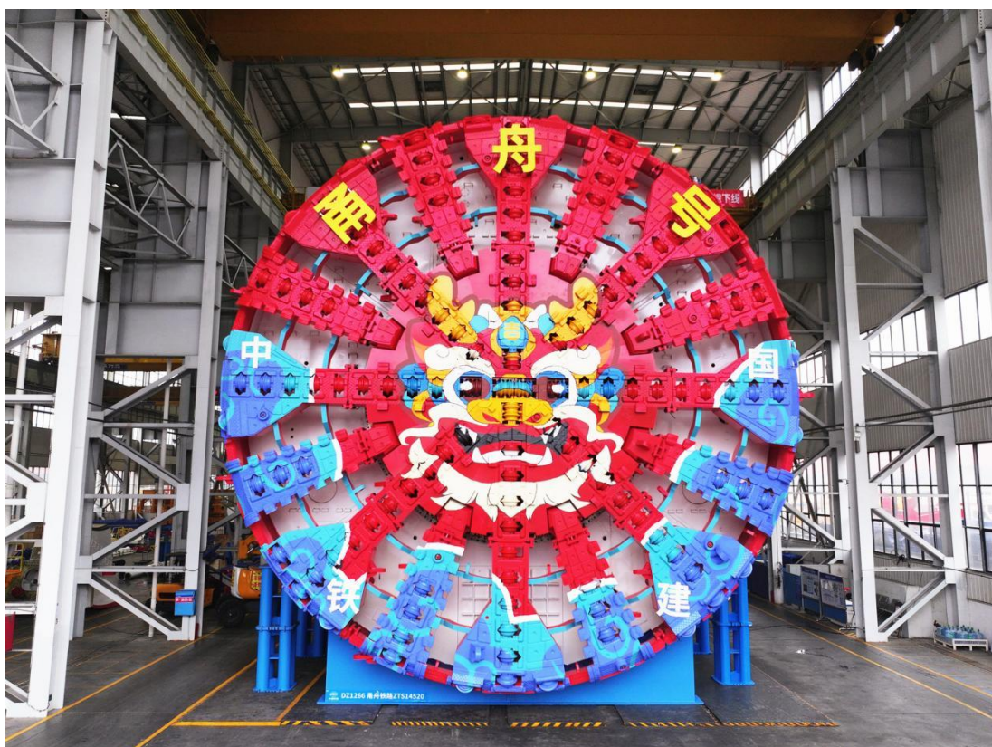
世界最长高铁海底隧道盾构机“甬舟号”
