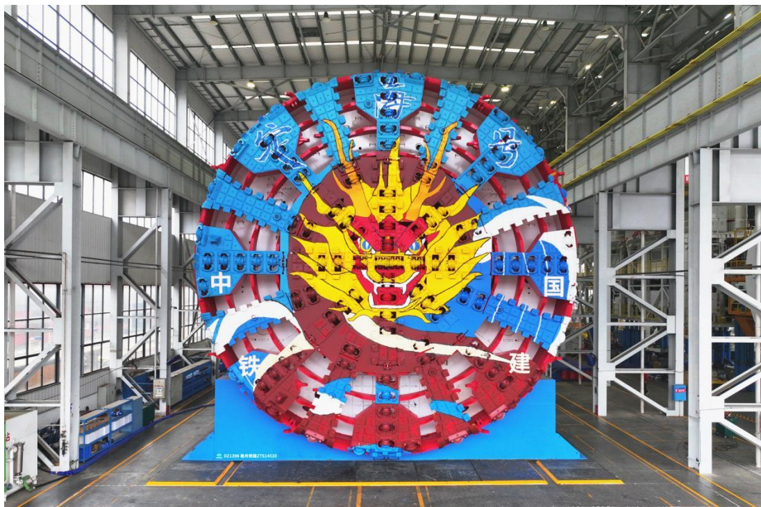
世界最长高铁海底隧道盾构机“定海号”
