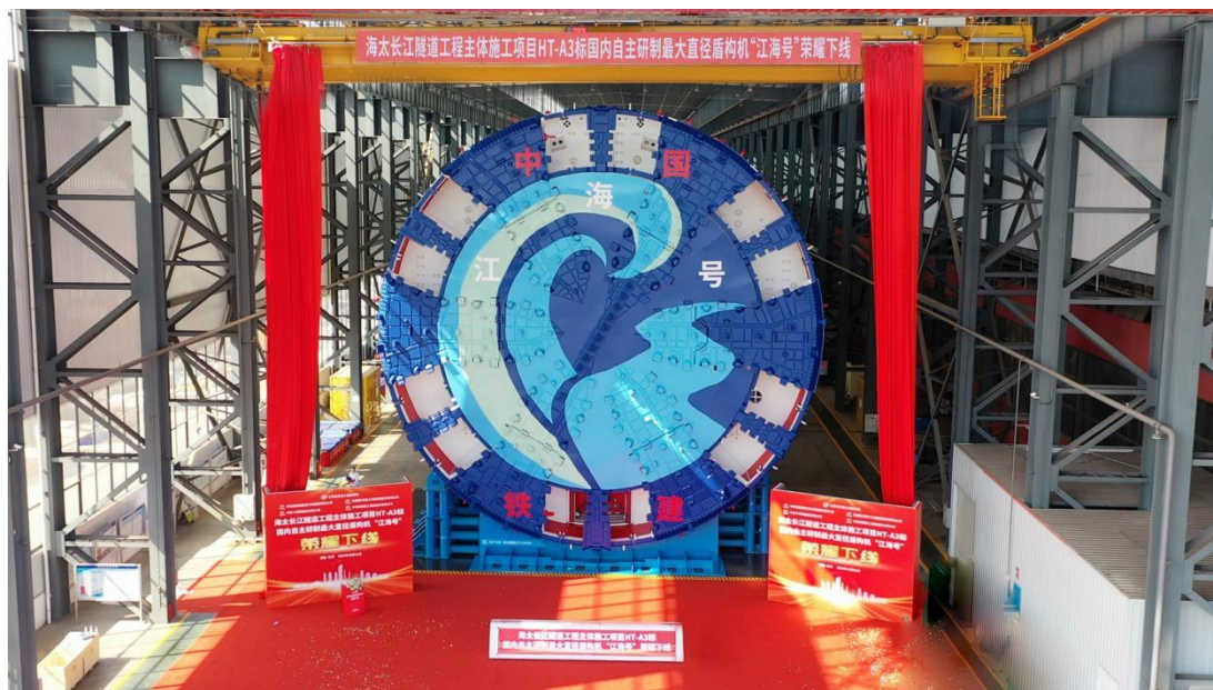
我国自主研制最大直径盾构机“江海号”
