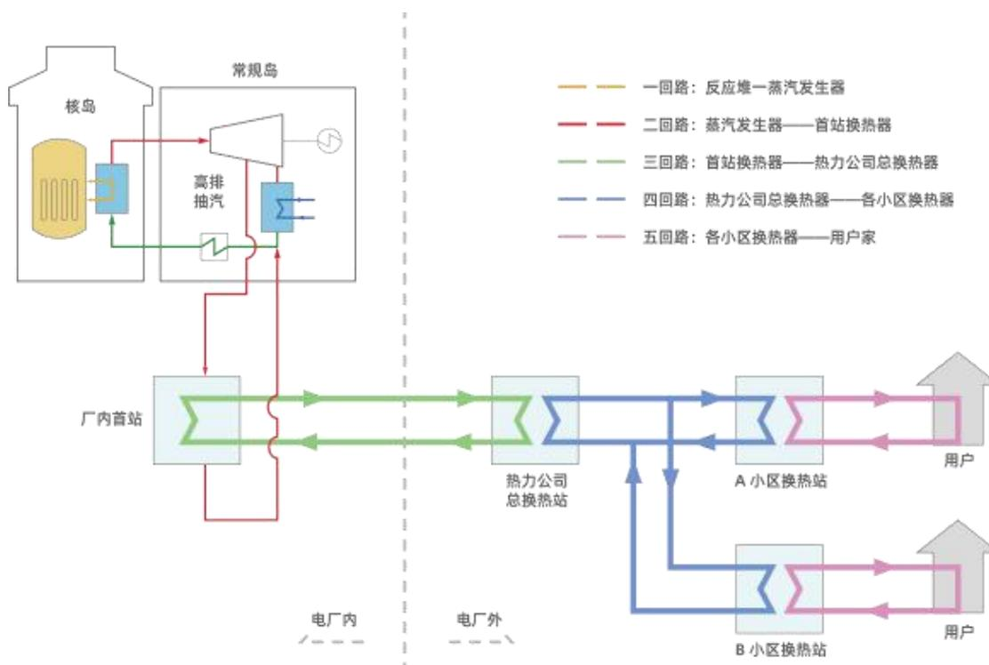
注：首先，一回路核反应产生的热量，通过蒸汽发生器，将二回路的水加热成高温高压蒸汽；二回路部分蒸汽被抽取用来加热核电厂内换热站的水，加热后的水通过三回路传送到热力公司总换热站；在总换热站，三回路继续加热四回路内的水；接着四回路的水就沿市政供热网络传输到小区的换热站中，将热量传递给五回路，进而送入千家万户家中，从而实现为居民供暖的目的。五个回路之间只有热量的传递，没有水的交换。核能供热用户接触到的是与传统供热方式一样的热水，并且通过三回路与二回路间的压差设计、在线监测等，实现多重屏障防御。
