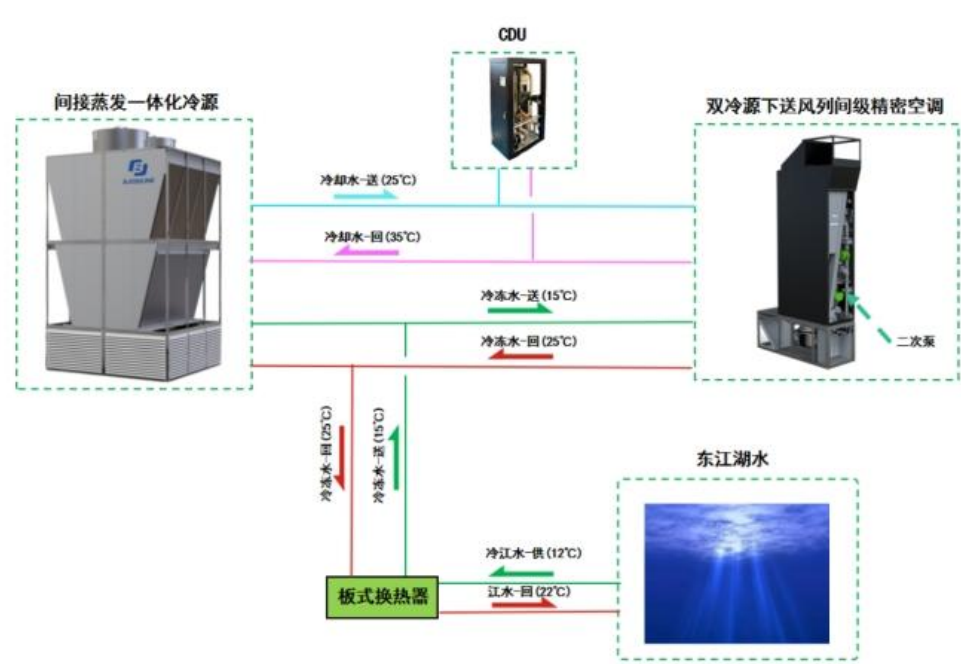
资兴智算中心制冷系统结构图
