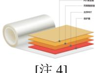
[注 4] | 柔性 OLED 屏内使用的功能膜，在模组生产中用于支撑柔性 OLED 基板，由于上层被贴合的 PI 基材及显示部分，非常薄且柔软易卷曲，支撑膜给整个模组起到了增加挺度以及保护 PI 层，避免被划伤的功能       |
