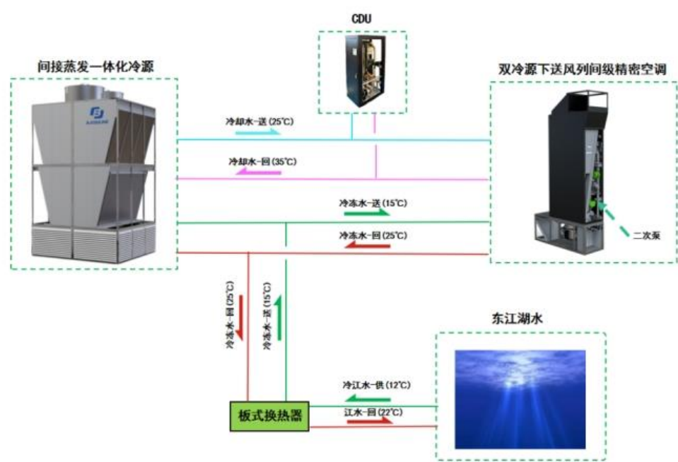
资兴智算中心制冷系统结构图
