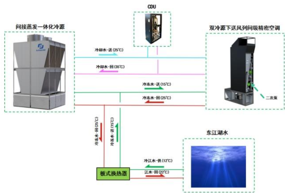
资兴智算中心制冷系统结构图
