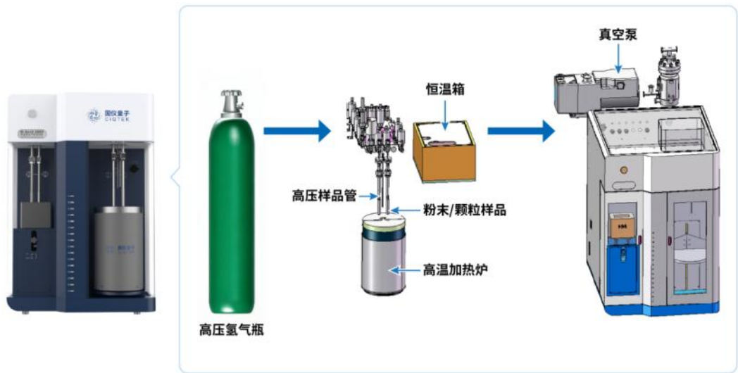
高温高压气体吸附仪结构示意图
